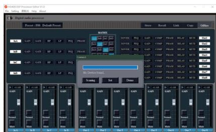
二，将电脑和处理器用USB数据线连接起来，打开处理器电源，此时电脑会自动找到新硬件并且提示硬件已安装而且可以使用。
