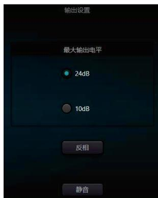
**最大输出电平:** 硬件最大输出电平, 24dBu、10dBu可切换。
