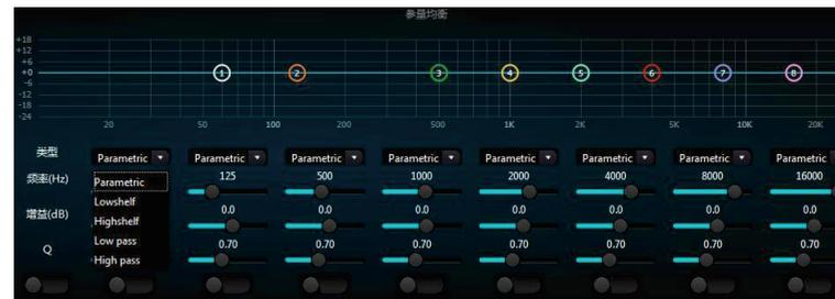
**类型**：默认参量均衡，可选高低架滤波器和高通滤波器。每一种滤波器有不同的形态，可完成不一样的功能。
