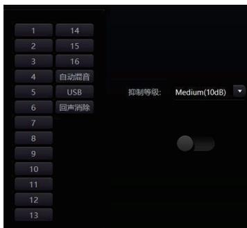
**抑制等级：**共有Mild(6dB)、Medium(10dB)、Aggressive(15dB)三种类型可选。dB的含义是抑制噪声降低多少dB，值越大，对语音的伤害也越大，这是无法避免的
